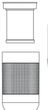
2. Ruotare in senso antiorario la base per accedere al filtro
