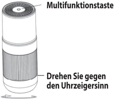
2. Drehen Sie den Sockel gegen den Uhrzeigersinn, um den Filter zu finden
